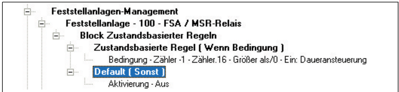
Bild 2.4 Summenzähler 16 im Feststellanlagen-Management
