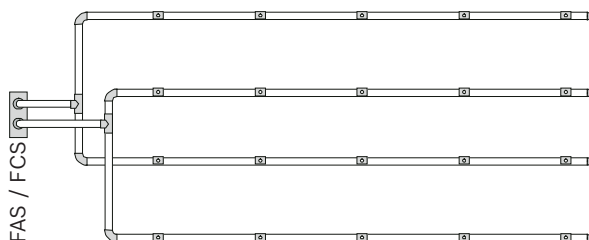
Rohrkonfigurationen für Zweimelderabhängigkeit
