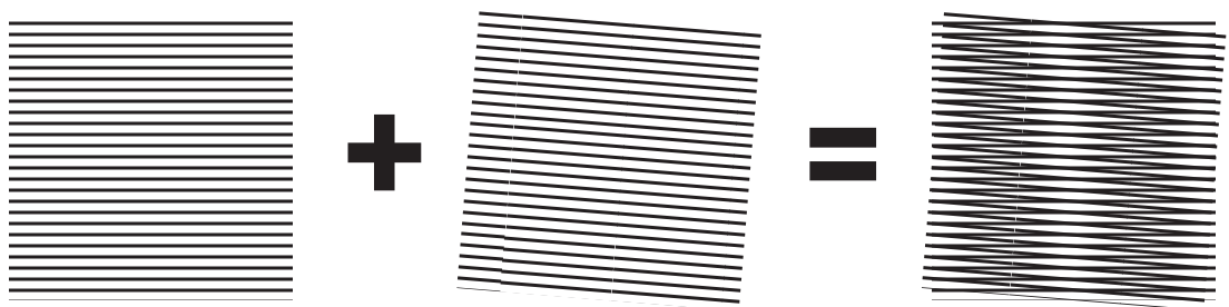
Figura 4.1: Efecto Moiré causado por dos patrones superpuestos (ejemplo)
